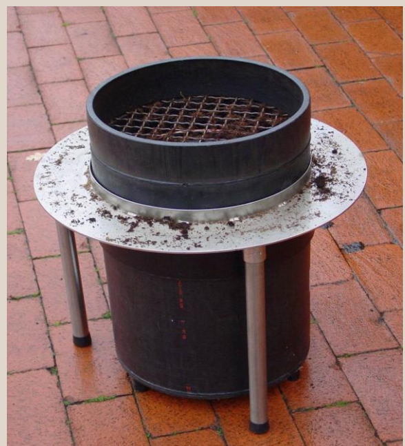
Abbildung 37: 20-l-Messzylinder nach DIN EN 12580 zur Bestimmung der Schüttdichte und Berechnung des Volumens von Substratausgangsstoffen, Kultursubstraten und Blumenerden (© G. Schmilewski).
